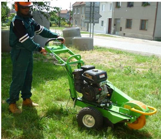
Au travail et au maniement de la raboteuse, l'opérateur doit se trouver derrière la manette de commande (voir la fig. – poste de l'opérateur). L'opérateur doit être debout solidement par les deux pieds sur un support résistant et doit tenir la manette par les deux mains.
